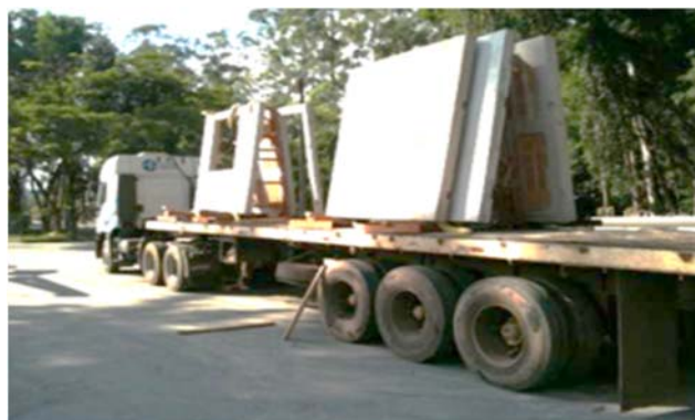
Figura 18 - Cavaletes para transporte dos painéis
