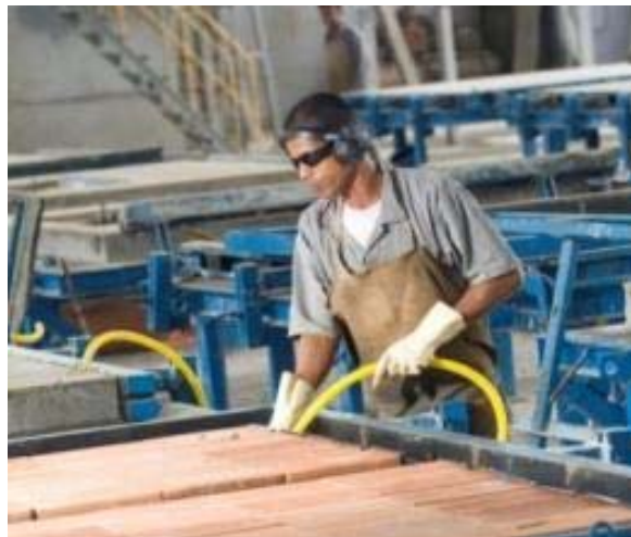
Figura 12 – Instalação dos eletrodutos
