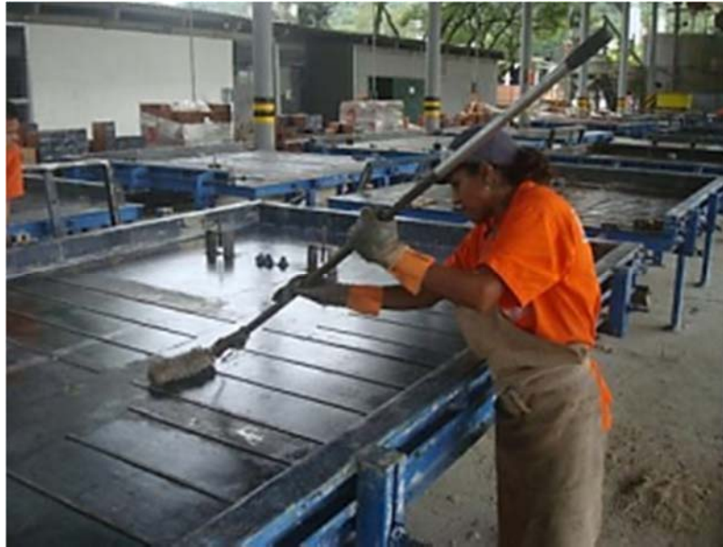
Figura 7 – Aplicação de desmoldante na fôrma
