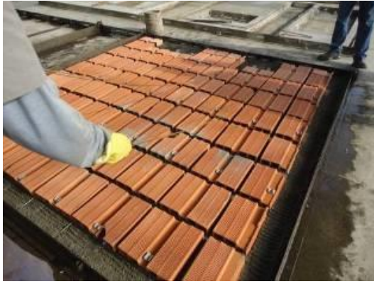
Figura 14– Posicionamento dos fios de aço para formação das malhas inferiores e superiores da armadura, conforme projeto de cada painel; detalhe dos espaçadores de argamassa.
